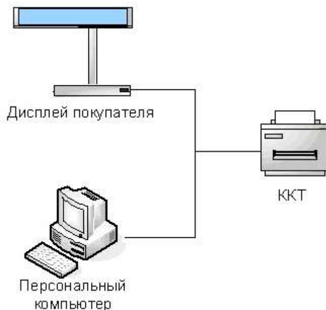
Рисунок 3. Подключение управляющих устройств к ККТ
